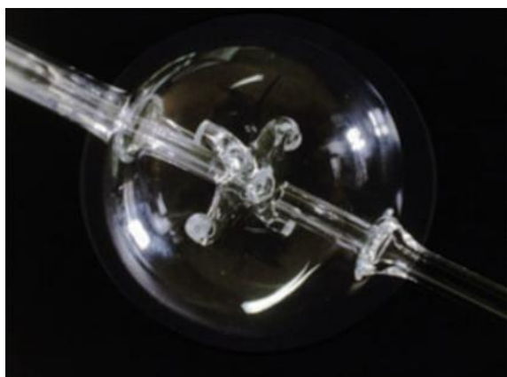
Figure 1. The jet stirred reactor used at the Laboratoire Réactions et Génie des Procédés (Nancy, France). Source of the figure: p. 186. of the book of Battin-Leclerc et al. [35].
